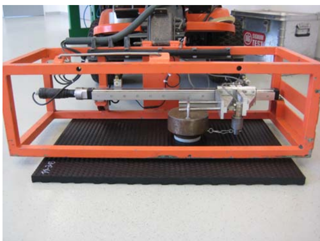
Bild 5: Messung der Rutschfestigkeit
